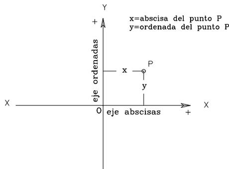
**Figura 1-1. Sistema de Coordenadas Rectangulares.**
