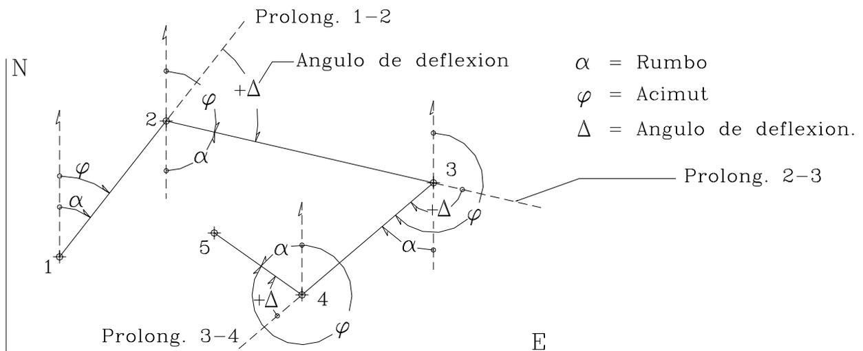
**Figura 1-16. Tipos de ángulos horizontales**
