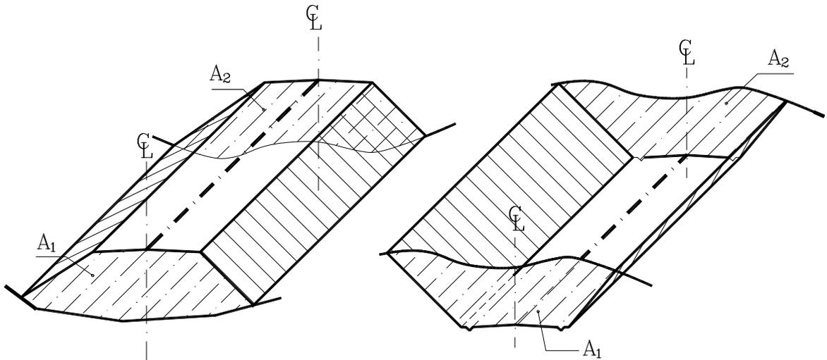
Figura 1-13. Volumen entre secciones del mismo tipo
