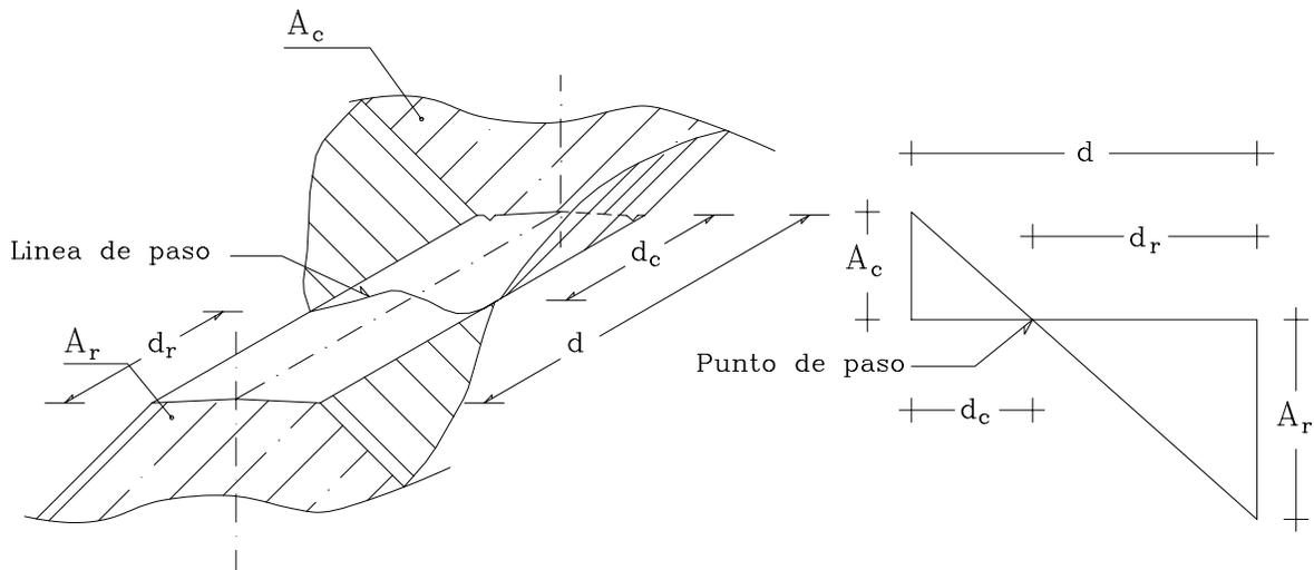
**Figura 1-14. Volumen entre secciones de diferente tipo**
