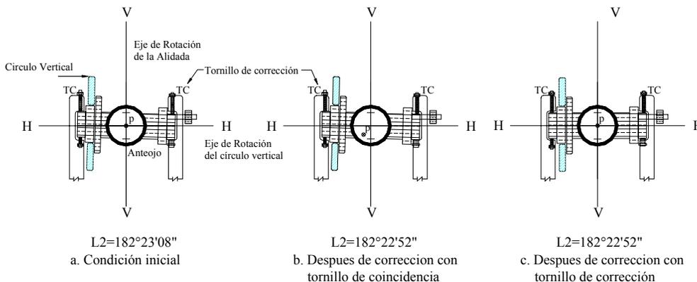
Figura 4.9. Corrección del error de inclinación
