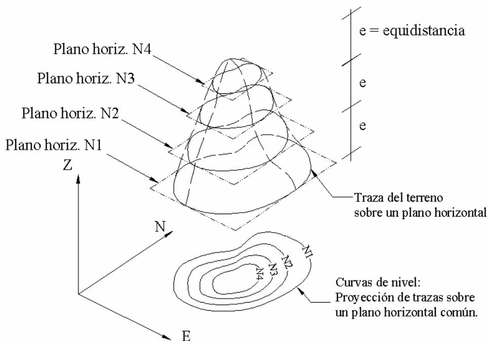
**Figura 7.4. Representación del concepto de curvas de nivel**
