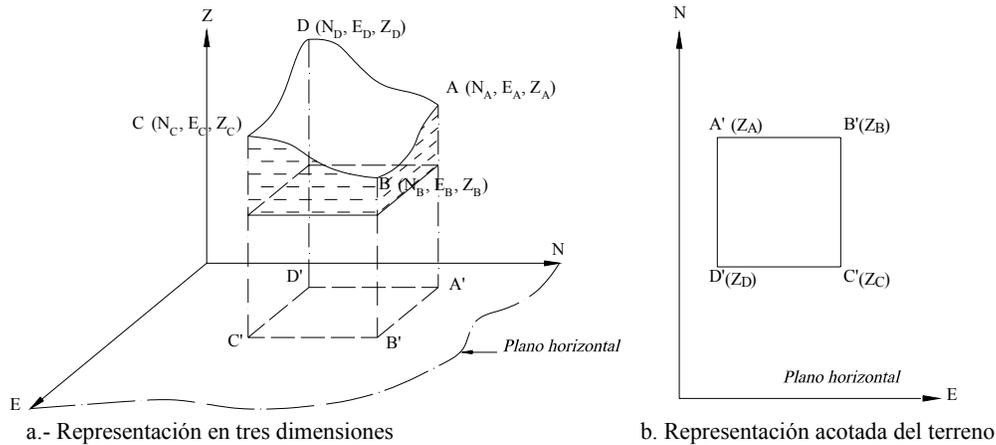
**Figura 7.2 Representación gráfica de una superficie de terreno**
