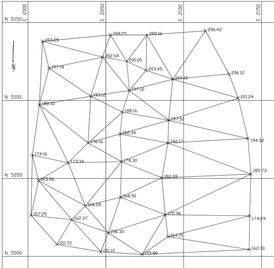
**Figura E.7.4.b. Red de triángulos utilizados en la interpolación**
